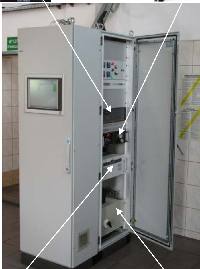
Urządzenie do pomiaru lotnych związków organicznych.
