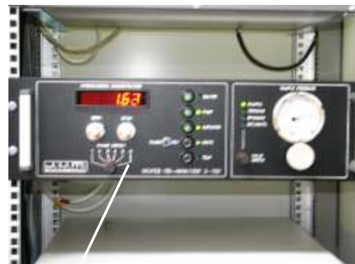
Urządzenie do pomiaru lotnych związków organicznych.
