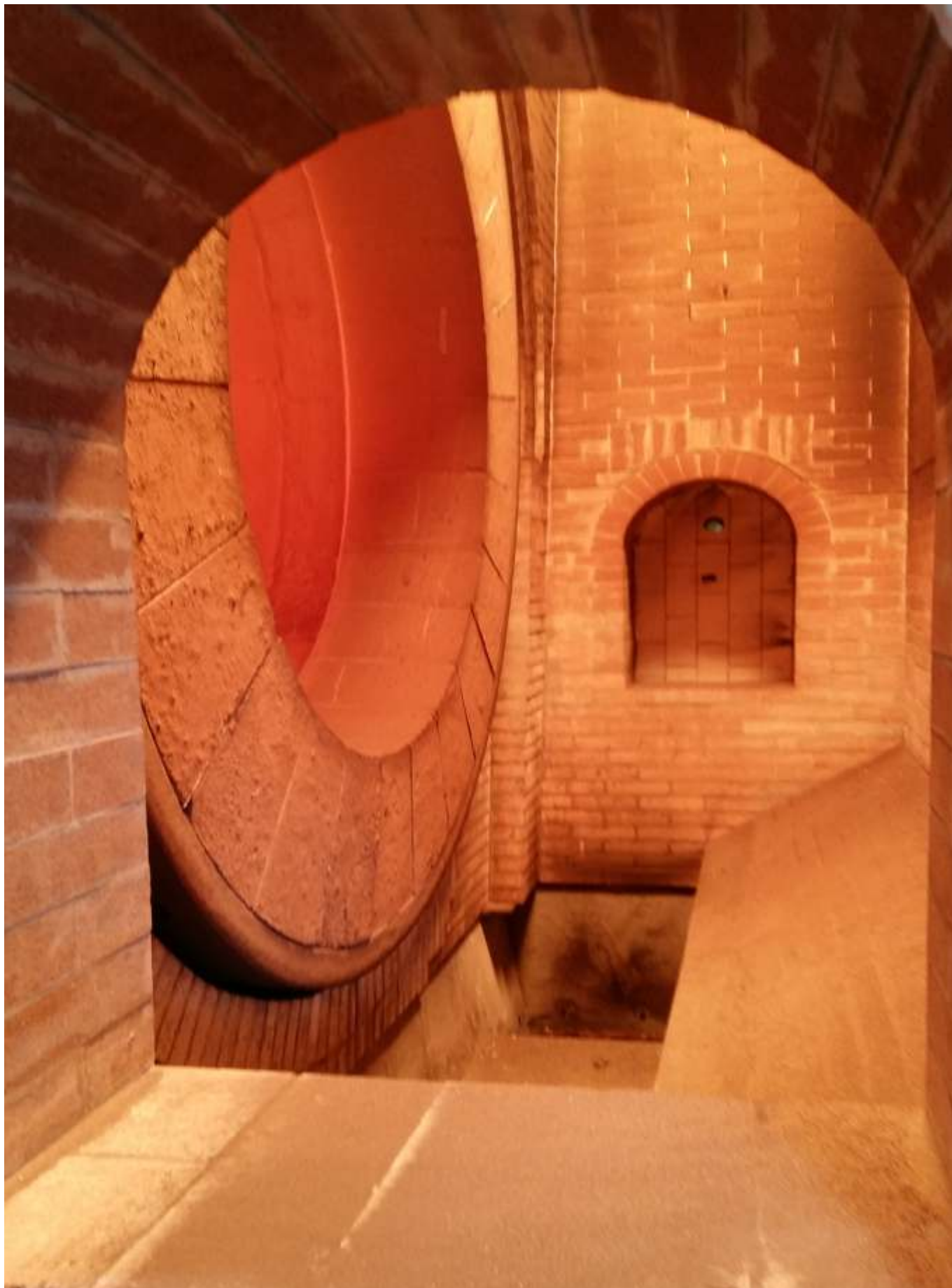
Komora dopalania wraz z piecem obrotowym - widok od wewnątrz.
