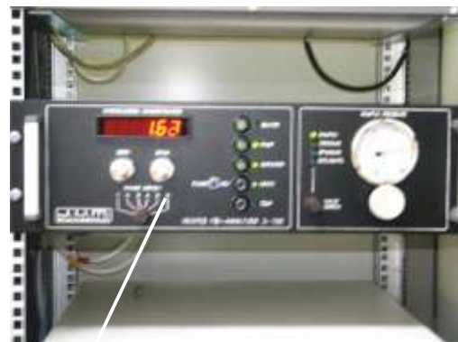
Urządzenie do pomiaru lotnych związków organicznych.
