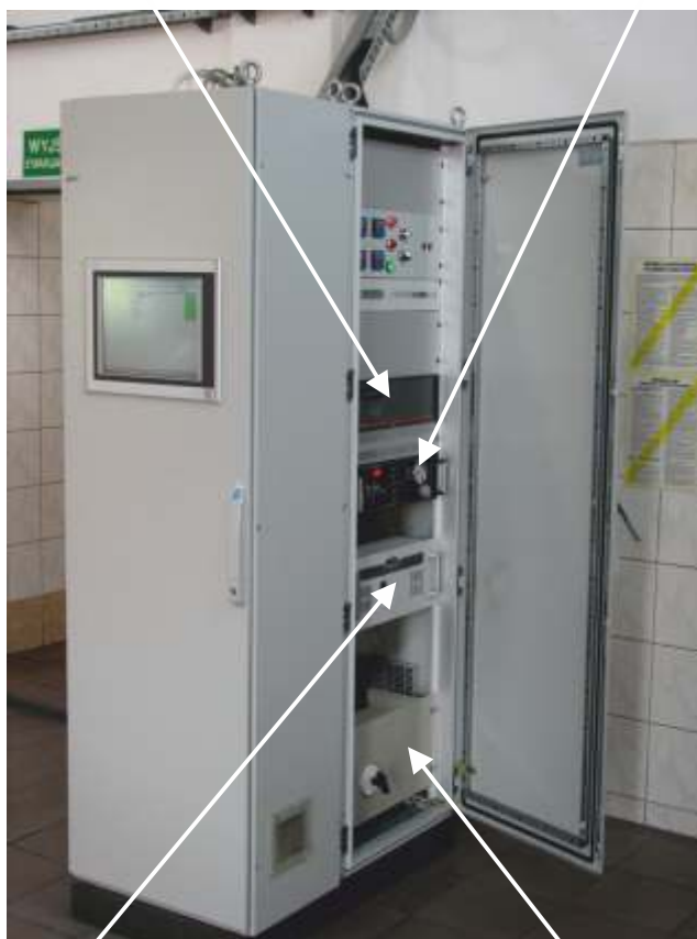
Urządzenie do pomiaru lotnych związków organicznych.
