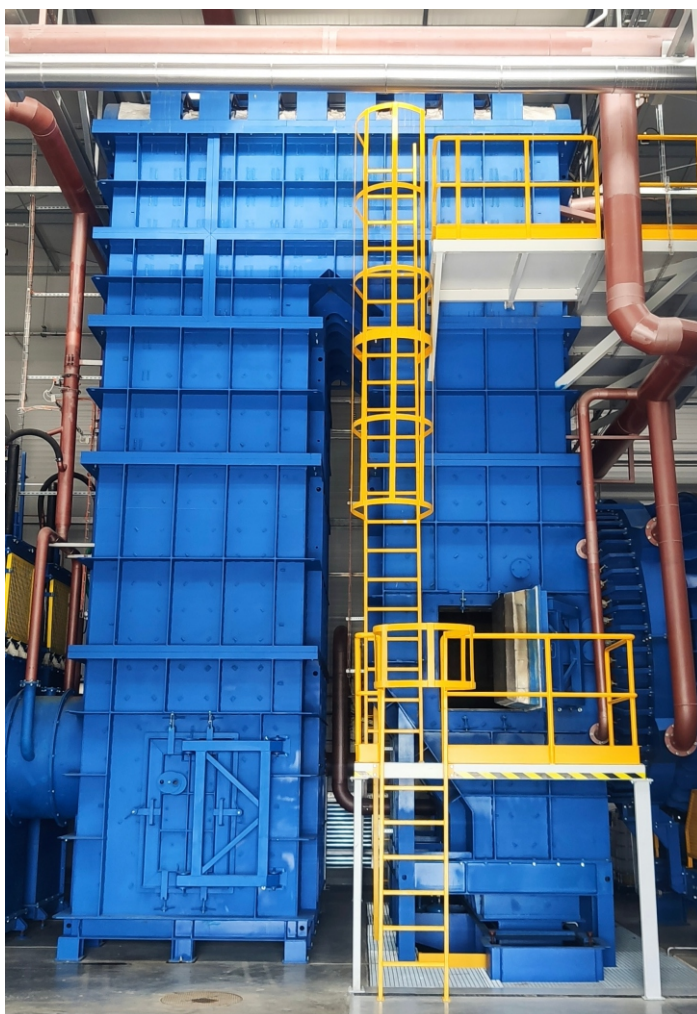
KOMORA DOPALANIA O WYDAJNOŚCI 400 kg/h
