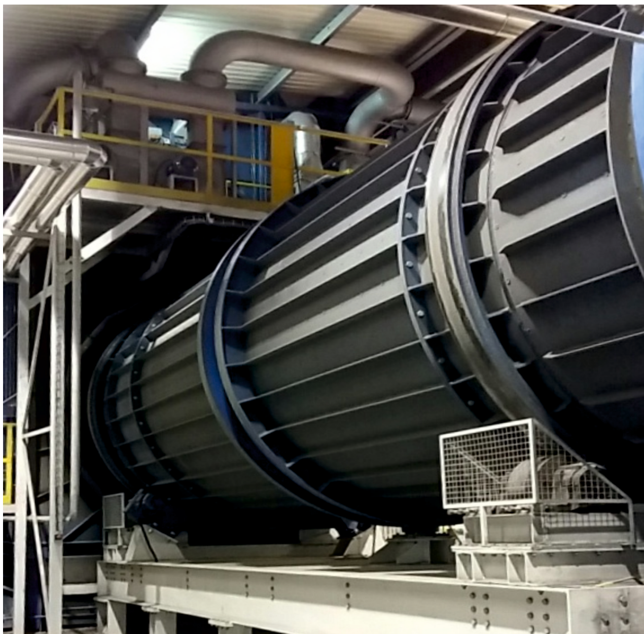
PIEC OBROTOWY O WYDAJNOŚCI 1250 kg/h
