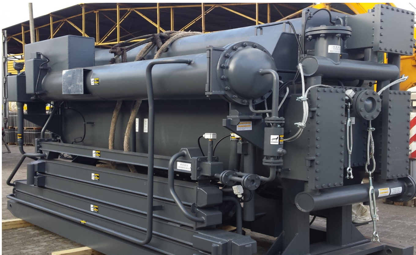
ABSORPCYJNA WYTWORNICA WODY LODOWEJ O MOCY Q = 0,6 MW
