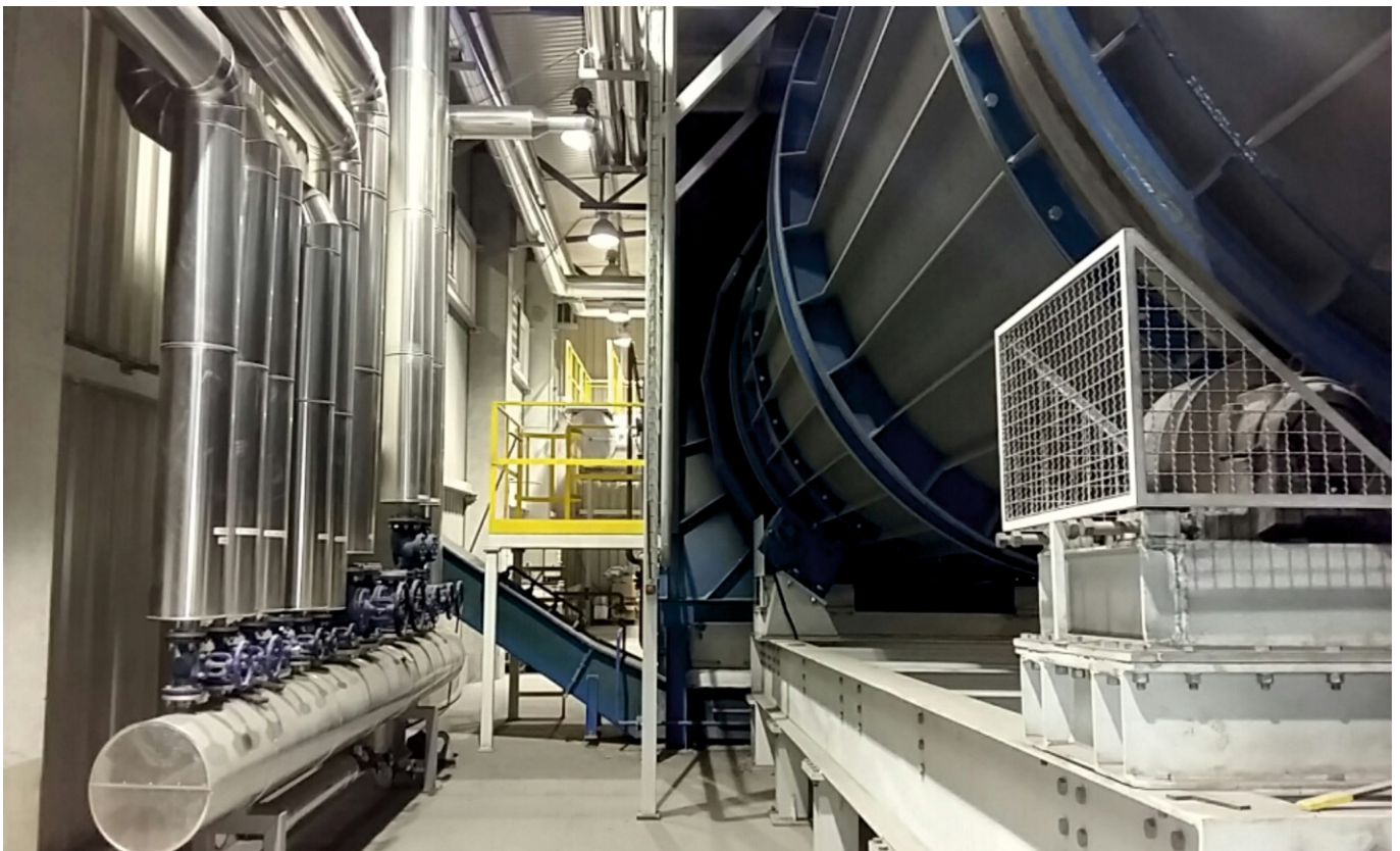
PIEC OBROTOWY O WYDAJNOŚCI 1250 kg/h
