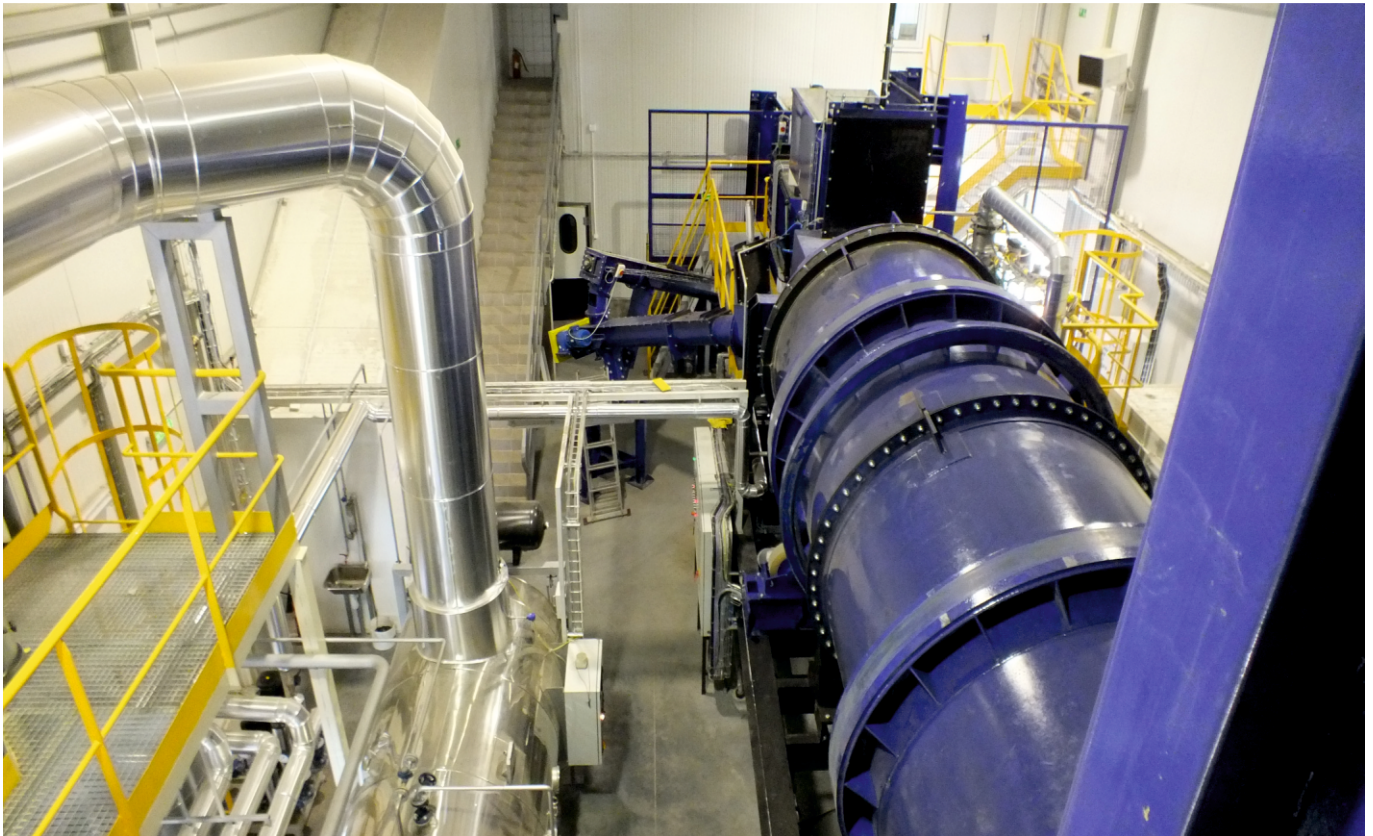
PIEC OBROTOWY O WYDAJNOŚCI 700 kg/h
